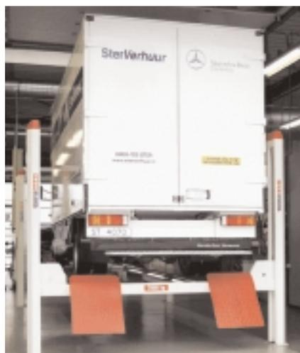
Auffahrschienen sind die ST 4055 und die ST 4070 sehr stabile Hebebühnen. Die schlanken und speziell geformten Säulen sorgen für eine maximale lichte Weite. Dies erleichtert das Auffahren breiter Fahrzeuge
