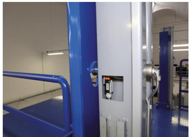
Detail der mechanischen Blockierung an der Etage.
