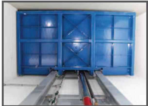
Die Konstruktion der Hebebühne wird mit transversalen Rohren längs der gesamten Hebebühne hergestellt und gewährleistet eine außergewöhnliche Robustheit, die auch sehr schwere Gewichte (1.500 Kg.) anhebt.
