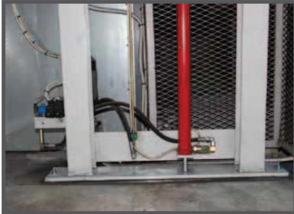
Die Konstruktion besteht aus zwei Säulen, die parallel geschweißt sind, um der Konstruktion mehr Festigkeit zu verleihen, sowie aus einem mittleren Hydraulikzylinder, der von Omer SPA hergestellt wird und mit einem entsprechenden Steuergerät verbunden wird.
