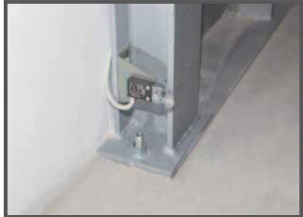
Die Hebebühne ist mit Endschalter zur Geschwindigkeitsreduzierung und zum entsprechenden Anhalten ausgestattet. Diese Systeme können nach Kundenwunsch eingestellt werden.
