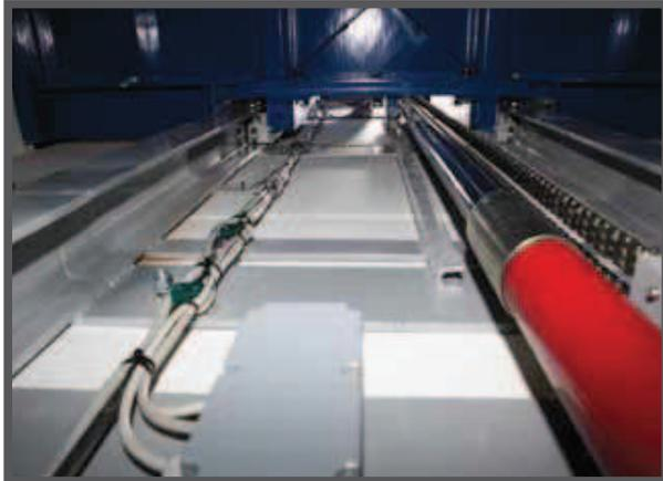
Die Komponenten wie Stromverbindung, Hydraulikleitung, Abzweigdosen sind zwischen beiden Säulen befestigt und sind für Wartungsarbeiten bequem erreichbar.
