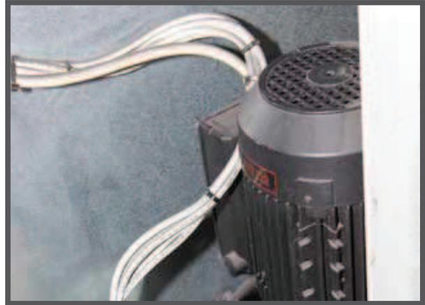
Das Steuergerät besteht aus einem Öltank, einem Steuer-schrank und einer Elektropumpe. Das Hydraulikaggregat benötigt 1m<sup>2</sup> Platz und ist für Wartungs- und Kontrollarbeiten bequem zugänglich.
