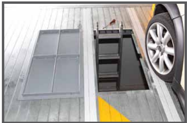
Zugangsöffnung zur unteren Hebebühne bei geöffneter Position.
