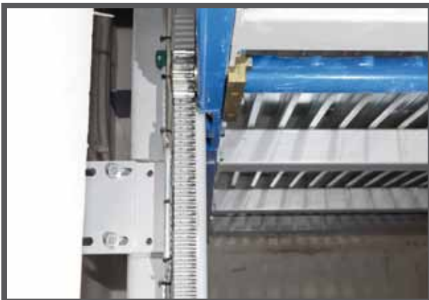
Zugangsöffnung zur unteren Hebebühne bei geöffneter Position.
