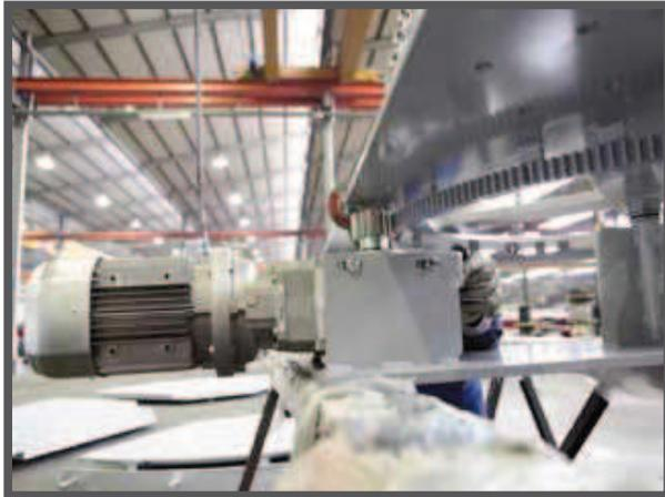
Die Einheit des Untersetzungsgetriebes bildet ein Stück mit der Struktur, die den mittleren Drehstift trägt. Die Einheit des Untersetzungsgetriebes wird so konstruiert, um die Installation zu vereinfachen und eventuelle Verbindungsfehler zu vermeiden.
