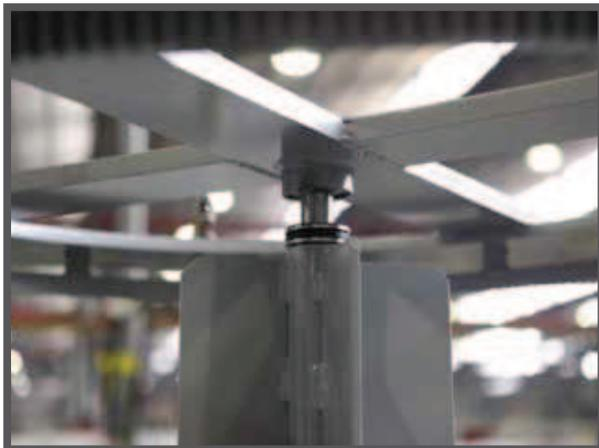
Die Anschlussstruktur ist am unteren Teil mit einer einrastenden Vorrichtung am mittleren Drehstift befestigt.
