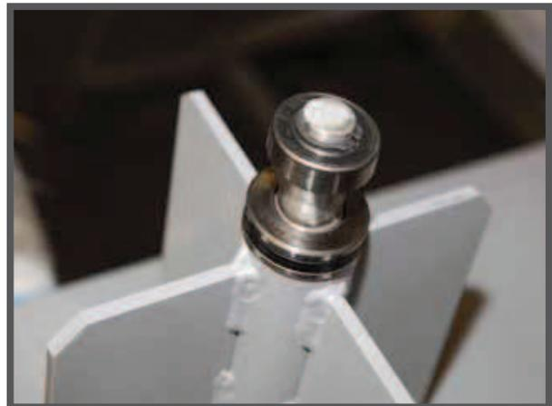
Der mittlere Drehstift mit Drucklager, der an der Motoreinheit positioniert ist, um die Gewichtskompressionen vollständig zu absorbieren, ist für die Einführung der Anschlussstruktur vorbereitet.
