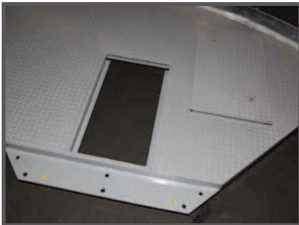
Das Bördelprofil der Grube fungiert auch als Gleitschiene für die Räder, um den Verbrauch durch Reibung mit dem lebendigen Zement zu vermeiden. Jeder Bördelteil ist mit einem Befestigungsflansch am nächsten Bördel ausgestattet, sodass die gesamte Führung ein einziges Stück wird. Außerdem sind auf der Rückseite dieser Führung einige Eisenstücke zur Befestigung mit dem Zement angeschweißt.
