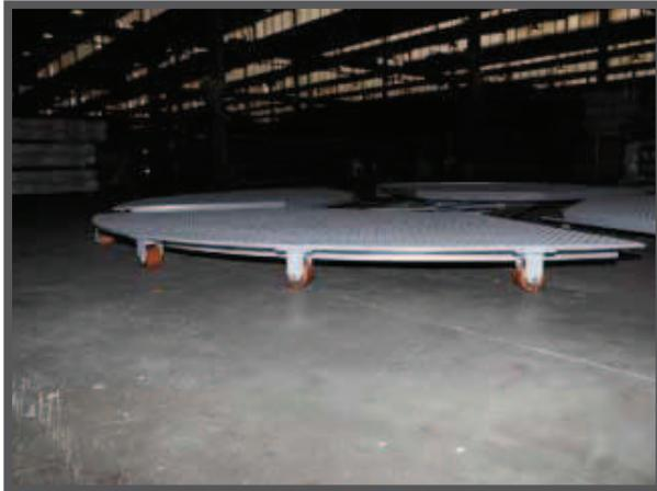
Jedes Stück, aus dem Ralla 25 zusammengesetzt ist, ist mit vier Polyurethanrädern ausgestattet, um soweit möglich die nicht vertragenen Lücken zu reduzieren und Verformungen der Hebebühne bei Nichtauswuchtung des Gewichts zu vermeiden. Die Geräuschentwicklung wird deutlich reduziert.
