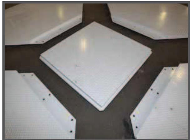
Nachdem die vier Stücke der Hebebühne an der Anschlussstruktur befestigt wurden, wird diese durch eine Deckplatte geschlossen, die die Fertigbearbeitung gleichförmig macht.
