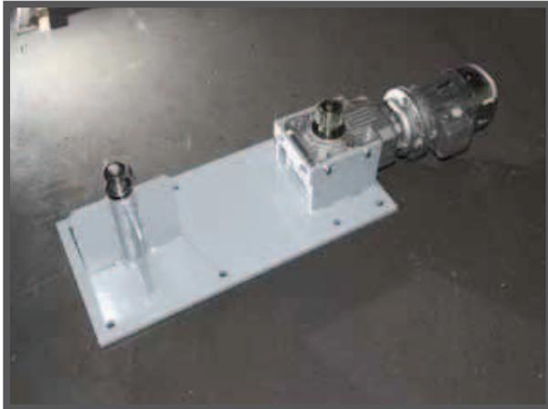
Einheit des Untersetzungsgetriebes mit mittlerem Drehstift und Drehritzel zur Verbindung mit der runden Zahnstange.
