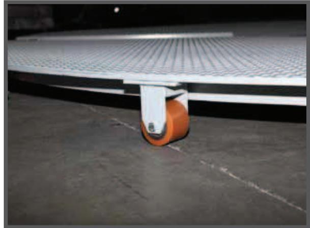
Die Polyurethanräder sind an der Struktur durch einen mechanischen Stift befestigt, der an einer „U-förmigen“ Struktur befestigt ist, die an der Hebebühne angeschweißt ist.
