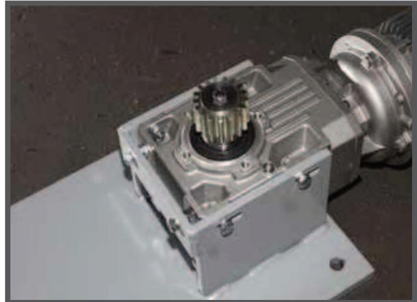
Detail des Untersetzungsgetriebes mit Drehritzel. Es sind Ösen mit Befestigungsbolzen sowohl an der Vorderseite (für eine Rechts-/Linkseinstellung) als an der Seite (für eine Vor-/Rückwärtseinstellung) zu sehen.
