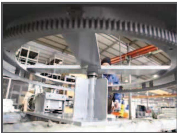
Detail der runden Zahnstange, die auf die Anschlussstruktur des Drehgestells angewendet wird, welche auf dem mittleren Drehstift liegt.
