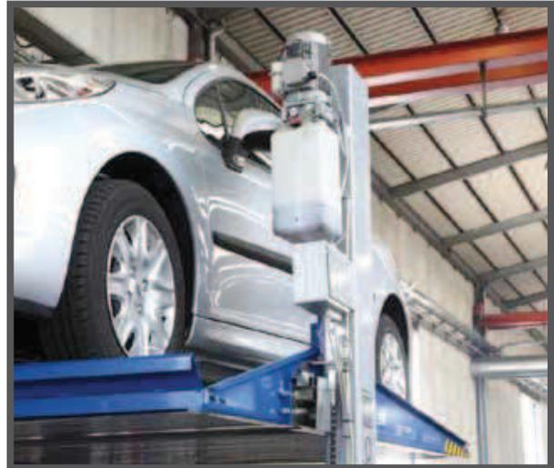
Unser Vorteil - starke, kompakte Bauweise und damit minimaler Platzbedarf für den elektro-hydraulischen Antrieb, das eigentliche Herz der Bipark.
