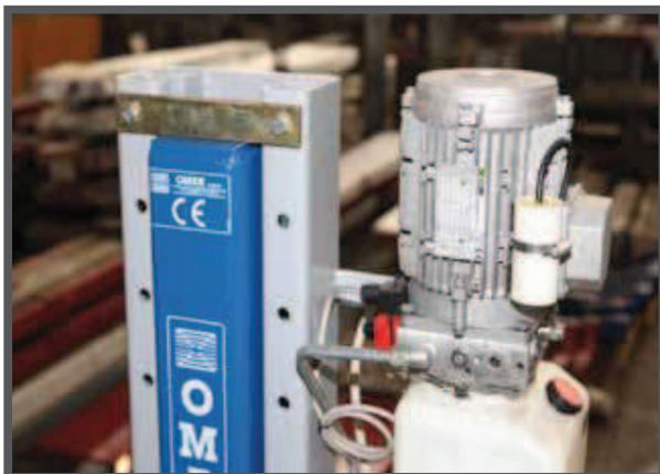
Die vertikale Hubblockierung der Hebebühne, die sich am Endstück der Säule befindet, garantiert Sicherheit und bestimmt den max. Hub der Auffahrt in Bezug auf die Anforderungen des Kunden.
