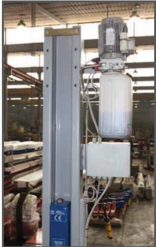
Die kompakte elektro-hydraulischen Einheit und Schalttafel, die am oberen Endstück der linken seitlichen Säule angebracht sind, ermöglicht maximale Effizienz bei minimalem Platzbedarf und verhindert jede Art von Hindernis beim Parken der Fahrzeuge.
