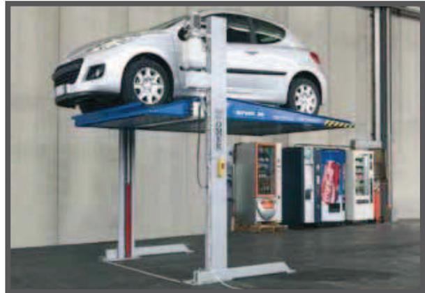
Die Tragkraft beträgt 2'600 kg, ist somit also auch für Fahrzeuge wie SUV und Geländewagen geeignet. Die Plattform aus galvanisiertem Profilblech ist wasserdicht und verhindert, dass darunter parkierte Fahrzeuge beschädigt werden.
