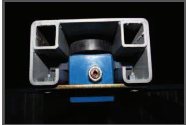
Das Detail von oben markiert den Hubwagen der Hebebühne.
