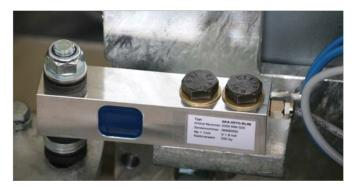
Die Prüfwerte werden über das bewährte DMS-Messprinzip erfasst. Diese verschleißfreie Messsensorik ermittelt zuverlässig und fehlerfrei die entstehenden Kräfte.
