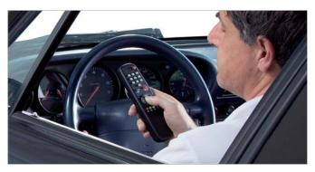
Mit der optionalen Funk-Fernbedienung können die Prüfgeräte vom Fahrzeug aus bedient werden, z.B. kann nur der Bremsprüfstand gestartet oder die Prüfreihenfolge beliebig vorgenommen werden.
