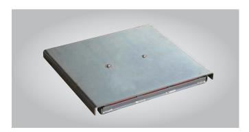
Mit dem Schnellspurtester kann die Spurabweichung des zu testenden Fahrzeugs gemessen werden. Es erfordert keinen zusätzlichen Prüfaufwand, da die Prüfplatte direkt vor dem Fahrwerktester oder Bremsprüfstand platziert und einfach überrollt wird. Die korrekte Diagnose der Vorund Nachspur erfolgt über die automatische Messwerterfassung. Der Messwert wird in 0 ± 20 mm/m angezeigt.
