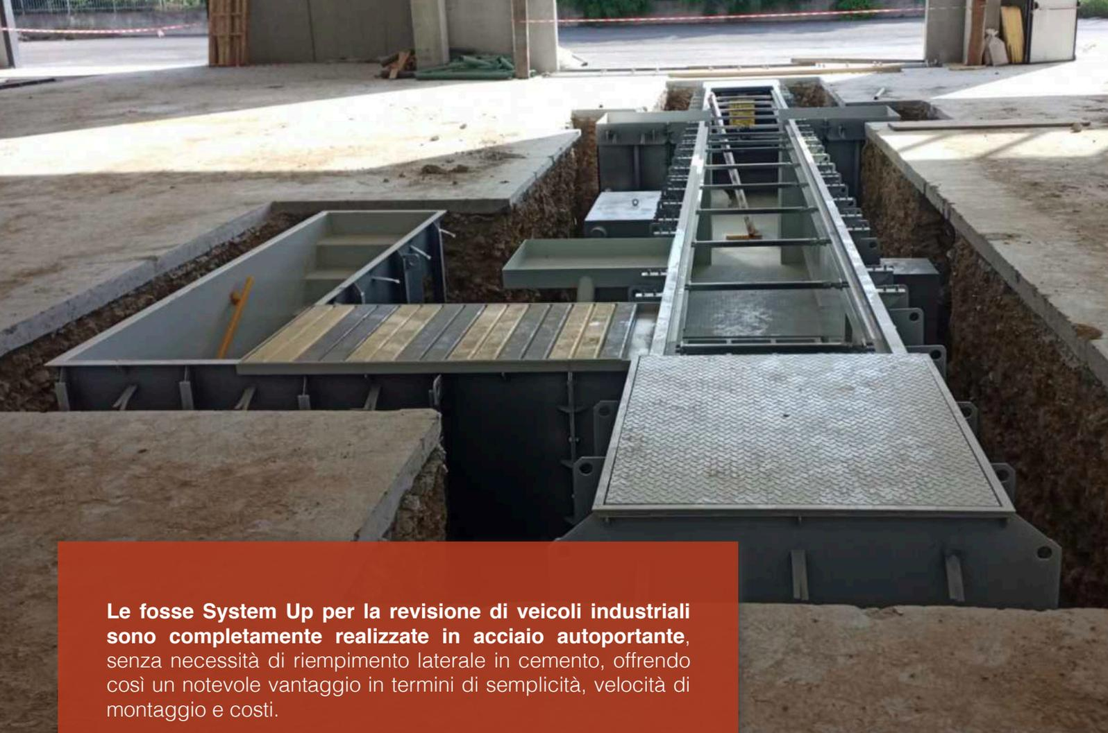
**Le fosse System Up per la revisione di veicoli industriali sono completamente realizzate in acciaio autoportante**, senza necessità di riempimento laterale in cemento, offrendo così un notevole vantaggio in termini di semplicità, velocità di montaggio e costi.
