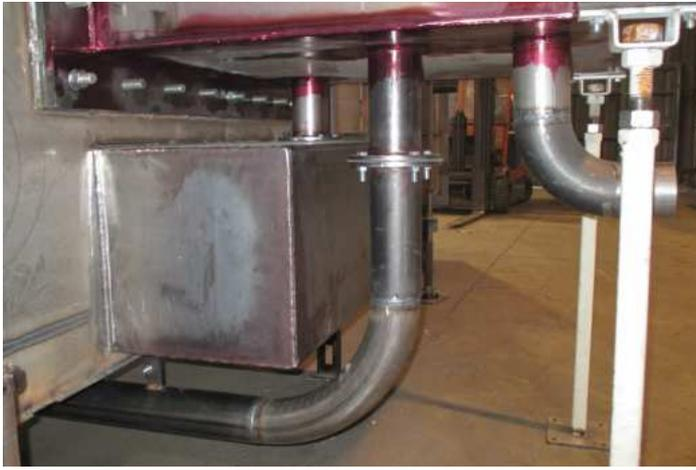
**Inserimento in fossa dei telai per alloggiamento prova giochi con relativi condotti per il passaggio tubi idraulici e cavi elettrici**
