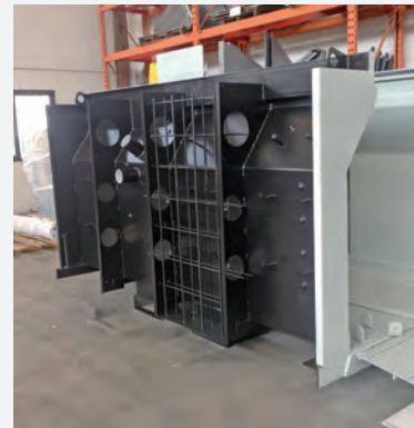
Parete a riempimento (mod RP) Fill-in wall (model RP) Wand mit Betonverfüllung (Mod. RP)
